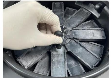
染色结束，有提示声提示，打开盖子，可用配套真空吸笔或手动取出片子即可在显微镜下观察。
